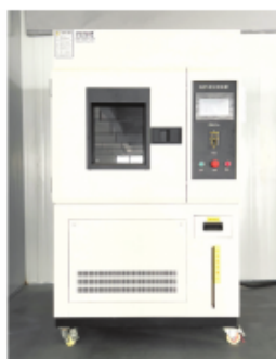
Камера для испытания на старение ксеноновой дугой
